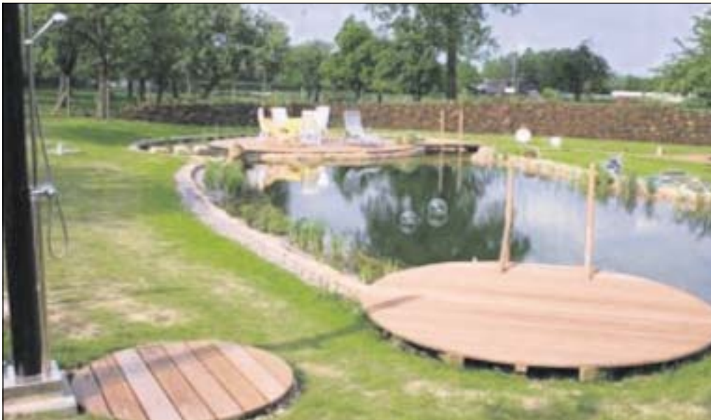
Schwimmteiche sind Pool und Teich in einem. Das Wasser wird im Regenerationsbereich auf rein biologische Weise gereinigt. Fotos: Privat
